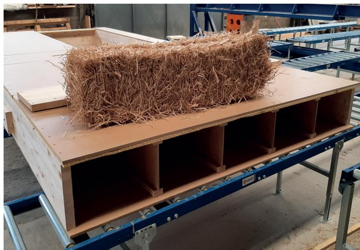
Ci-dessus, vue de fabrication du caisson avec remplissage paille.
